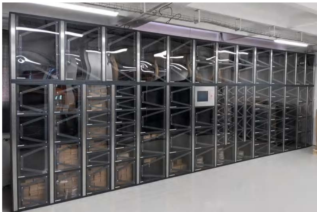
Système avec hauteur spéciale jusqu'à 2,48m pour la gestion des produits bruts et des produits semi-finis fabriqués
