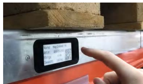
Signalisation ESL sur chaque emplacement de palette
