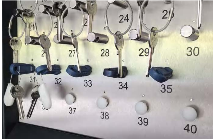
Fentes pour clés avec fiches de sécurité verrouillées, fiches d'identification bleues non verrouillées
