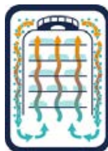
Le schéma montre la circulation d'air frais dans la chambre de l'autoclave.
