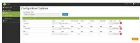
L'appareil MG-BACnet dispose d'un WebServer intégré en charge de collecter et de fournir la visualisation des données. Une fois connecté via une liaison filaire (câble RJ45 fourni) à un poste informatique local ou à un réseau d'entreprise pour être accessible depuis tous les postes, vous pourrez accéder directement au menu de votre capteur.
