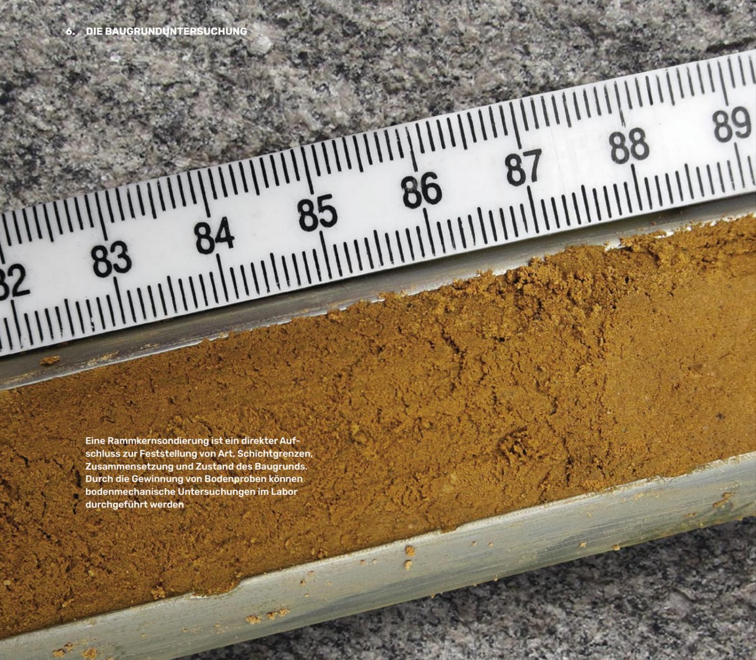
Eine Rammkernsondierung ist ein direkter Aufschluss zur Feststellung von Art, Schichtgrenzen, Zusammensetzung und Zustand des Baugrunds. Durch die Gewinnung von Bodenproben können bodenmechanische Untersuchungen im Labor durchgeführt werden
