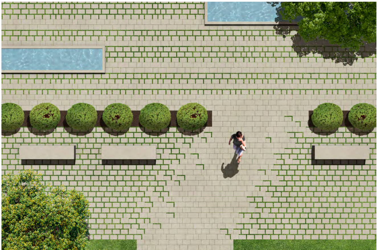
Schwammstadt Variante 1.2: Mehrsteinsystem Typ BJ, GDM.TETRAGO gap 30/20/8 und 20/20/8 cm, Reihenverband
