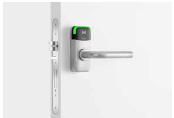
Elektronischer Kurzbeschlag speziell für DIN 18251 Türen mit DIN 18250 Einsteckschlössern. Durch die Nutzung der vorhandenen DIN-Lochgruppe für Türrosetten lässt er sich bohrungsfrei montieren.
