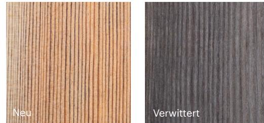
UC3-Standard entspricht, und anschließend unter Vakuum mit Leinöl gekocht. Das Öl dringt zwei bis drei Millimeter tief ins Holz ein, bildet eine wasserabweisende Schutzschicht und hebt die Maserung hervor. Leinöl wird aus Flachssamen gewonnen, ist biologisch abbaubar und verursacht im Vergleich zu synthetischen Lacken deutlich weniger CO<sub>2</sub>. Nach der Linax-Behandlung ist das Holz installationsbereit und erfordert nur minimale Wartung.
