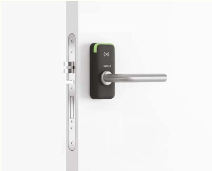
Das DIN-Modell des XS4 Mini wurde speziell gemäß den Anforderungen für DIN 18251 Türen mit DIN 18250 Einsteckschlössern entwickelt. Durch die Nutzung der vorhandenen DIN-Lochgruppe für Türrosetten lässt er sich bohrungsfrei montieren.
