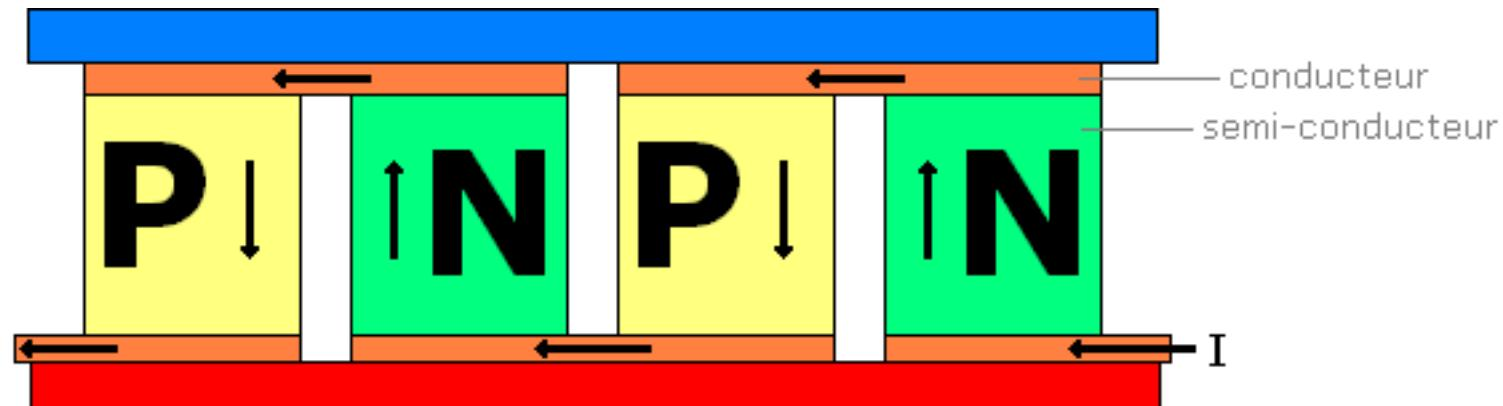
L'effet Peltier correspond à un phénomène physique qualifié **d'effet thermoélectrique**. Il se manifeste par un déplacement d'énergie sous forme de chaleur induite par la présence d'un courant électrique.
