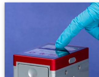
Le PCA 200 est équipé d'un écran tactile intégré.
