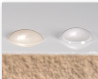
Mesurer l'énergie de surface avec deux liquides d'essai.
