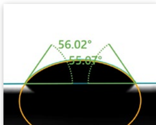
Mesure de l'angle de contact à l'aide du logiciel dpiMAX
