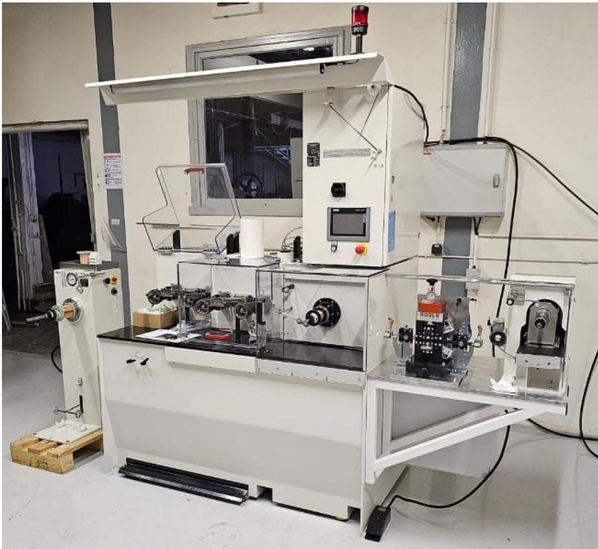
Banc complet avec dérouleur de bobine, banc de tréfilage, tête de laminage et enrouleur (avec trancannage).
