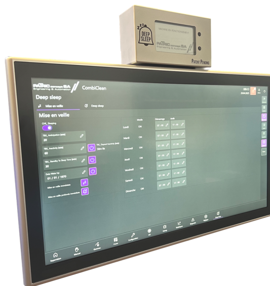
Ecran HMI avec module DeepSleep en programmation
