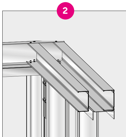
SK111 UK EA04 – Zusätzlicher Befestigungsträger, Abstand ca. 150 mm
