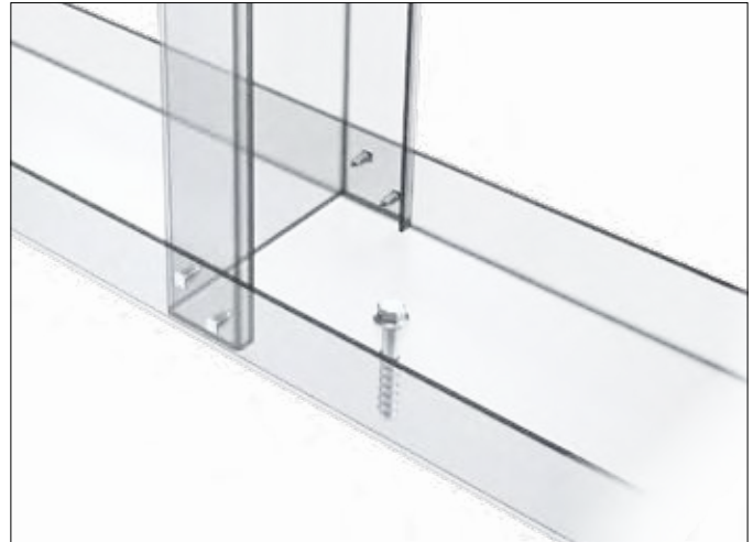
Abb. 1: Diagonale Verschraubung Bodenanschluss
