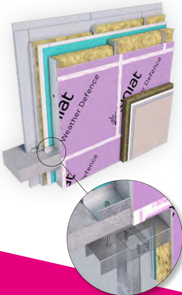
Abb. 1: eingestellte Infill Wall mit innenliegender Vorsatzschale
