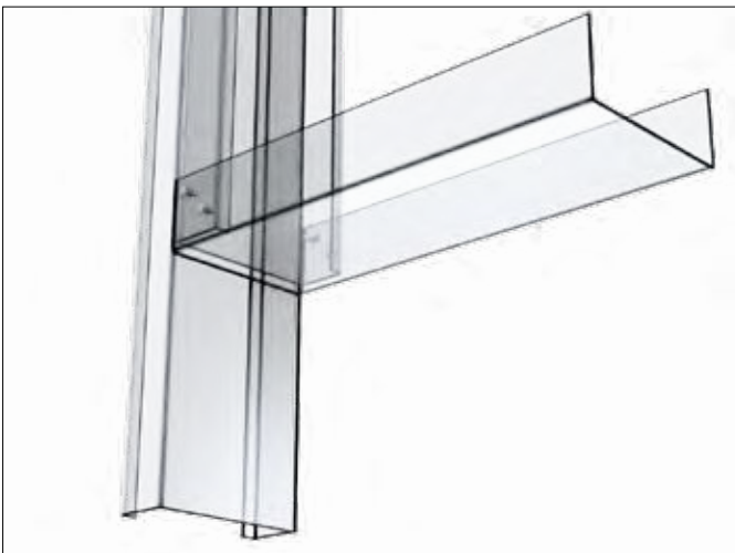
Abb. 3a: Wechsel für Einbauten mit 2 mm starken U-Profilen als horizontale Riegel (Sturz), verschraubt mit C-Profilen
