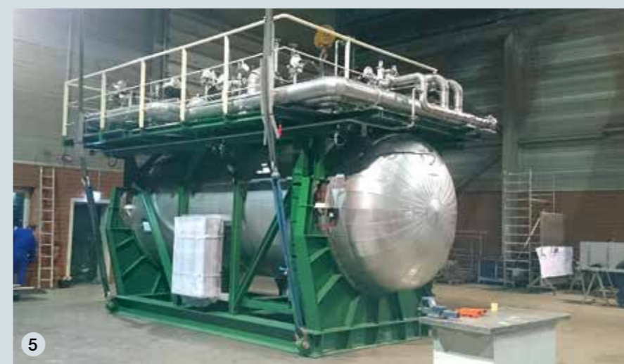
1: Skid de distillation pour une bio-raffinerie (long. 36 m, 66 t) | 2: Générateur de gaz inerte 3: Skid de traitement du Biodiesel | 4: Skid de traitement des eaux usées | 5: Réservoir haute pression 500 bar pour navire GNL
