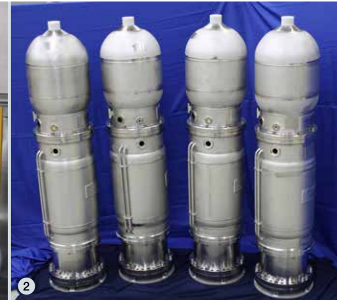
1: Cylindre d'entraînement pour chaîne de pasteurisation (Secteur Agroalimentaire) | 2: Equipement sous pression à gaz Rhesus pour la gestion de ballasts de sous-marins | 3: Corps de vannes (Secteur agroalimentaire) | 4: Elément de tuyauterie d'alimentation en carburant pour le lanceur Ariane 5 | 5: Corps de pompe avec filetage (Secteur des pompes & vannes) | 6: Corps de débitmètre Coriolis | 7: Panier de stockage & transport de combustible nucléaire
