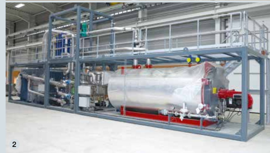
1: Skid de distillation pour une bio-raffinerie (long. 36 m, 66 t) | 2: Générateur de gaz inerte 3: Skid de traitement du Biodiesel | 4: Skid de traitement des eaux usées | 5: Réservoir haute pression 500 bar pour navire GNL
