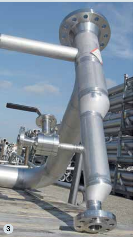
1: Tête de puits (Secteur Pétrole & Gaz amont) | 2: Coude en segments pour système de ventilation | 3: Spool haute pression pour application maritime | 4: Séparateur (traitement de l'eau) | 5: Corps de réacteur SCR pour traitement des fumées | 6: Pièces d'adaptation (secteur Oil & Gas) | 7: Manifold pour système de désalinisation de l'eau de mer
