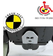
Plaque d'arrimage Dahl montée sous châssis
